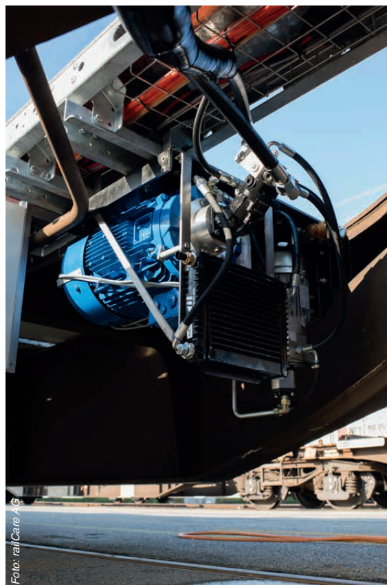
Das Achsgenerator- System besteht aus einem Hydraulik- generator, Energie- umwandler und Akkupaket
