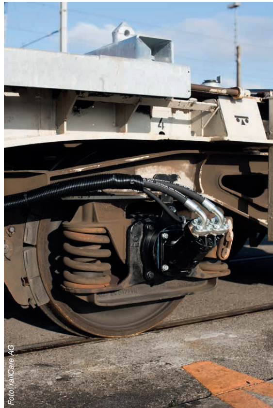
rCE-Powerpack®: Der am Achsenende angebrachte Generator
